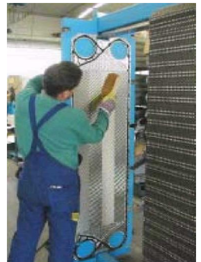
Рис. 10. Очистка поверхности пластины с помощью мягкой щетки.
